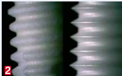
Fot. 2. Nagwintowanie śruby implantu Patent w porównaniu z innym dostępnym na rynku systemem
