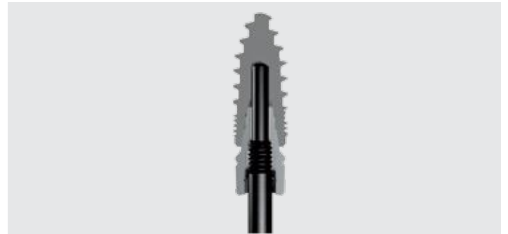
50 Implant z Shuttle ściągnaczem w przekroju poprzecznym.
